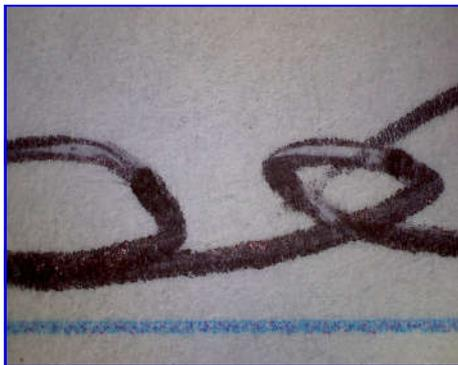
Il solo microscopio (senza distanziali) in **modalità 40x**, riprende un campo oggetto (sul lato più lungo del sensore) di circa **7,8 millimetri**.
