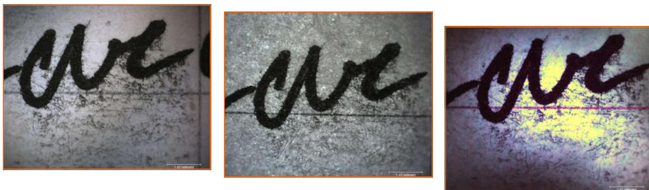
L'esempio si riferisce alla acquisizione di un tratto eseguito con pennarello molto ricoprente, in cui sono chiaramente visibili delle macchie di inchiostro. Le riprese sono state eseguite rispettivamente: nel NIR, a luce trasmessa nel visibile e in UV.
